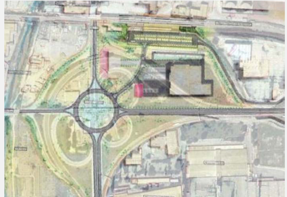
Figura 34. Superposició de la situació actual del nus amb la proposta de nova rotonda i accessos a l'intercanviador
