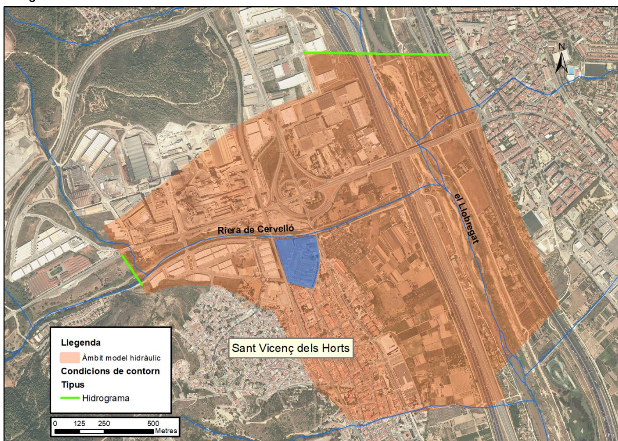
Imatge 28: Localització de les condicions de contorn d'entrada introduïdes al model hidràulic
