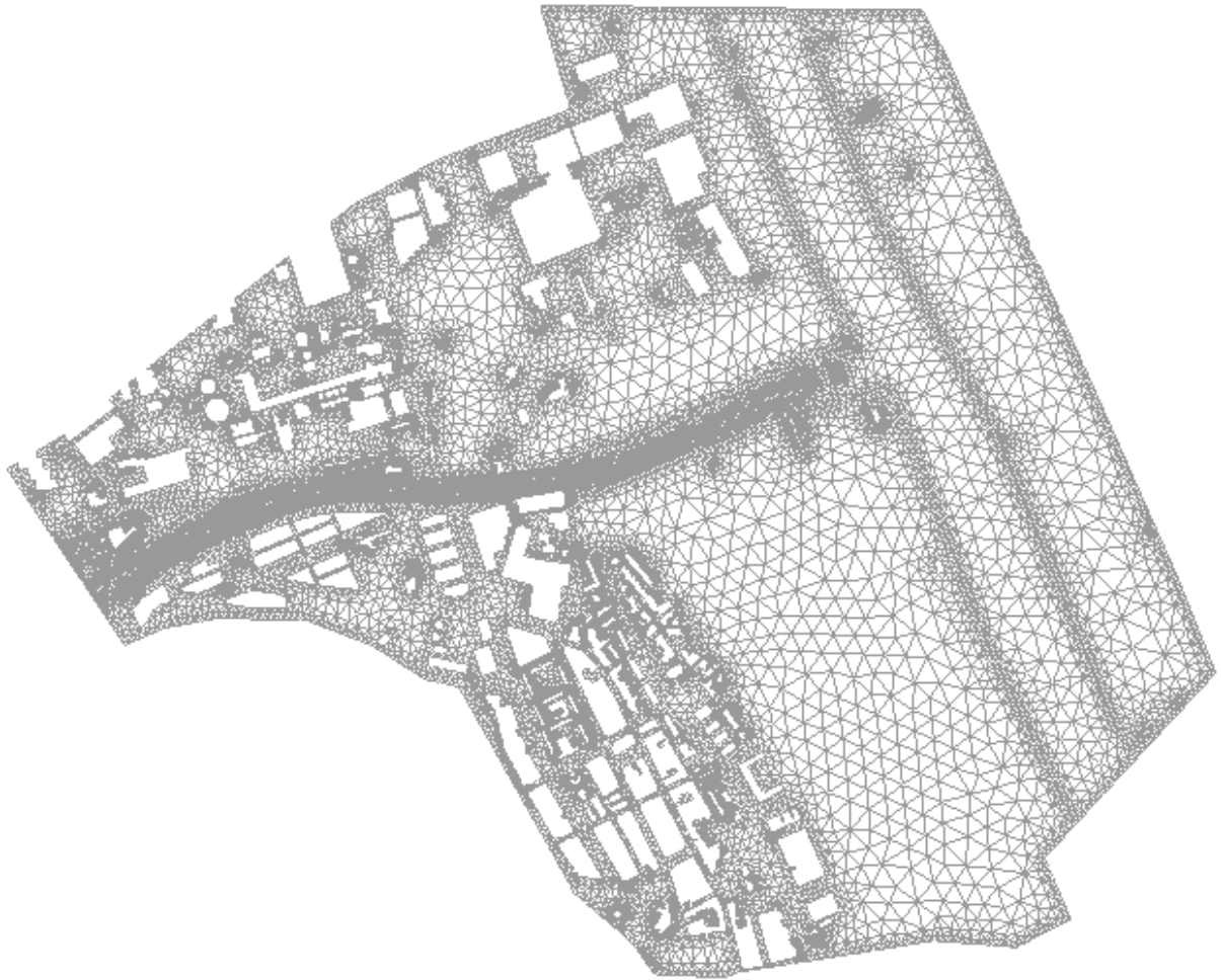
Imatge 27: Vista de la malla de càlcul emprada en el model
