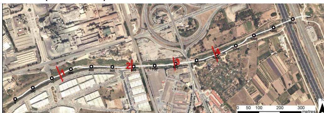
Imatge 31: Traça del perfil longitudinal de la riera de Cervelló (línia blanca) i de les seccions transversals analitzades (línies vermelles)
