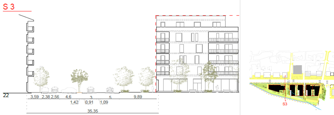
Imatge 66 Secció de la BV-2002 amb els dos fronts edificats. Font: Memòria del pla.
